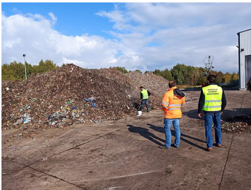
Fot. nr 9. Pobieranie próbek do badań aktywności tlenowej (AT4) odpadów pochodzących z dwustopniowej stabilizacji tlenowej frakcji nadsitowej odpadów komunalnych.
